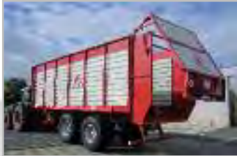
nabudowa ze ścianą przesuwaną
